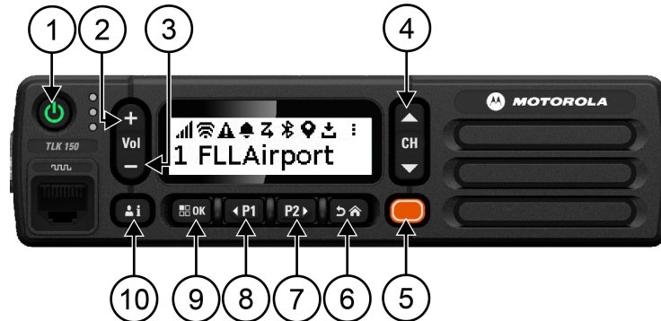
Πίνακας 3 : Επισκόπηση ασύρματου πομποδέκτη
