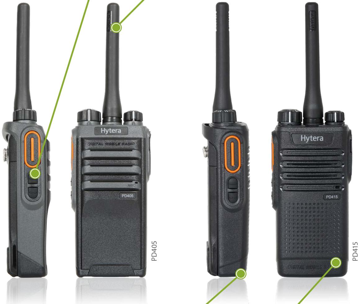
Integrierter RFID-Reader für Wächtersystem (PD415)
